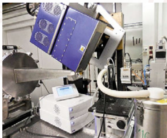
↑ obr. 1 – Prístroj D16 pre malouhlovú difrakciu neutrónov (ILL, Grenoble, Francúzsko).
