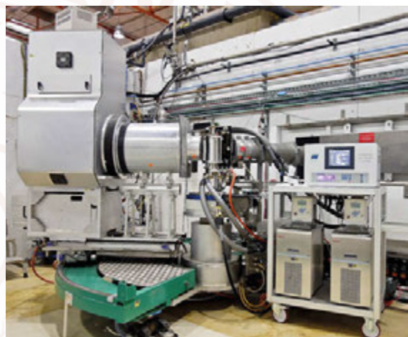
↑ obr. 1 – Prístroj D16 pre malouhlovú difrakciu neutrónov (ILL, Grenoble, Francúzsko).
