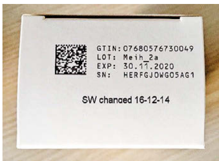
Obr. 5 Ukážka 2D Data matrix čiarového kódu na obale lieku, z ktorého je vidieť, že v kóde sú zakódované okrem číslíc aj písmená aj špeciálne znaky
